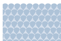
Abgeflachtes Korn einer Schleifscheibe
